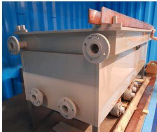
Figura 1. Depósitos de recirculación salmueras y coagulante producido.
